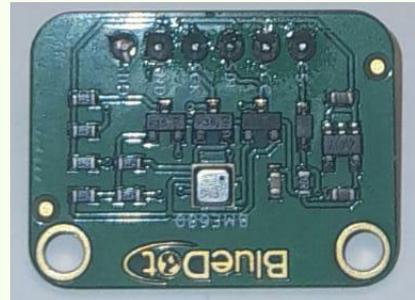
BlueDot BME680 è un sensore per l'umidità, pressione, e temperatura dell'aria +TSL2591 Comunicazione I2C.
