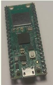
Raspberry Pi Pico W, è un microcontrollore con capacità wireless (internet e bluetooth)
